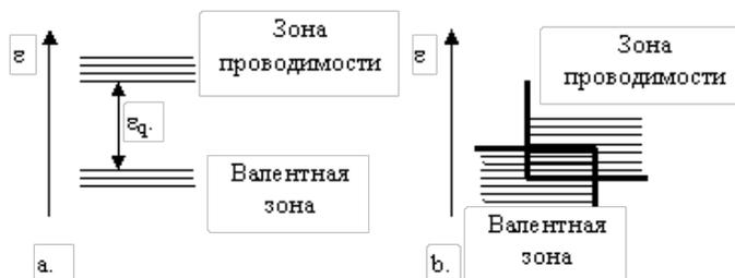
Рисунок 2.4. Зонная диаграмма металлов: а) валентная зона частично заполнена электронами; б) валентная зона и зона проводимости взаимно перекрываются
