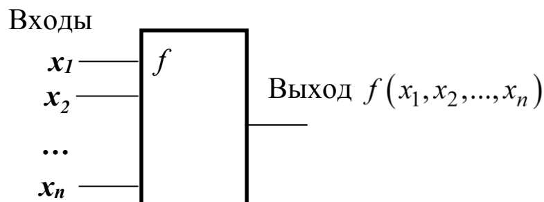
Рис. 2.1. Условное графическое обозначение логического элемента, реализующего булеву функцию f(x_1, x_2, \dots, x_n) .
